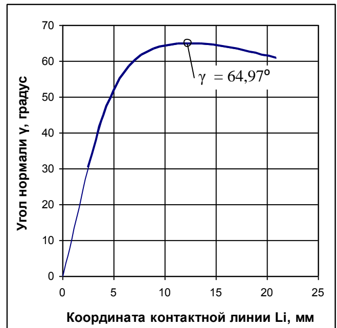
Рис. 5. Изменение угла нормали \gamma по длине контактной линии
