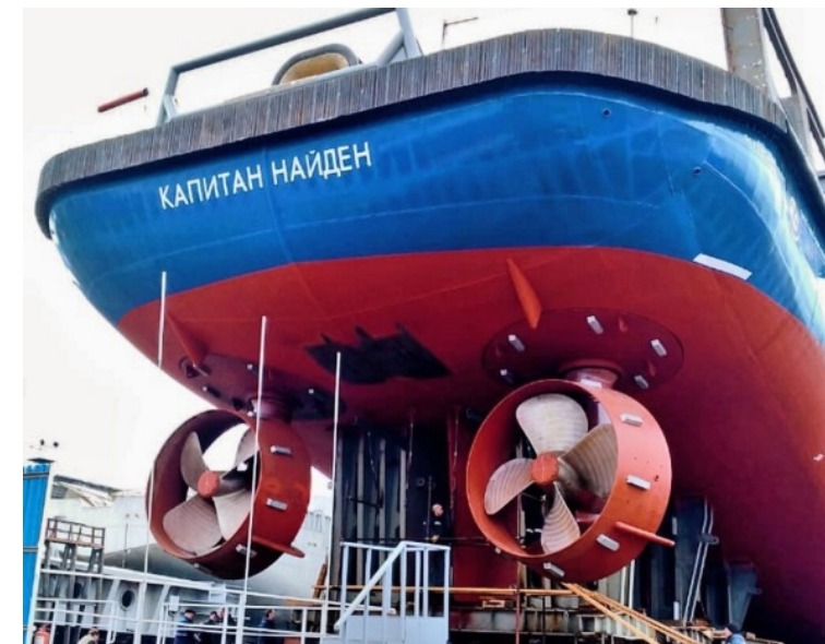
Буксир “Капитан Найденов” с ЭЦ-ВРК-2,5 ледового класса (Arc 4) спущен на воду 2.12.2019г. для нужд МО. В 2021 году сойдут ещё два буксира с ЭЦ-ВРК.
